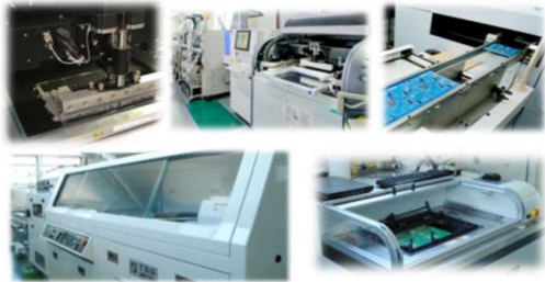
印刷機 (DEK) : HORIZON03iX / HORIZON 02i 半田印刷検査機 (CKD) : VP5200L-V マウンター (YAMAHA発動機) : YS24+YS100 / YSM20R リフロー装置 (エイテックテクトロン) : AIS-20-82C (千住金属) : SNR-1050GT Ver.4.00 リフロー装置 (エイテックテクトロン) : AIS-20-82C (千住金属) : SNR-1050GT Ver.4.00 DIP噴流槽[有鉛] (セイテック) : TOM-7-350 DIP噴流槽[無鉛] (セイテック) : TW-400L ポイント半田付け装置 (セイテック) : STS-2533Sj
