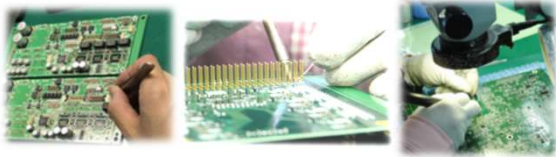
半田コテ（白光） : FX-951 (その他、用途により高周波半田コテ、リペア機、フロー 等を使用)
